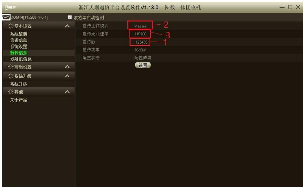
步骤 1 设置数传模块 ID 号，接收模块与发射模块必须设置相同数传模块 ID。
