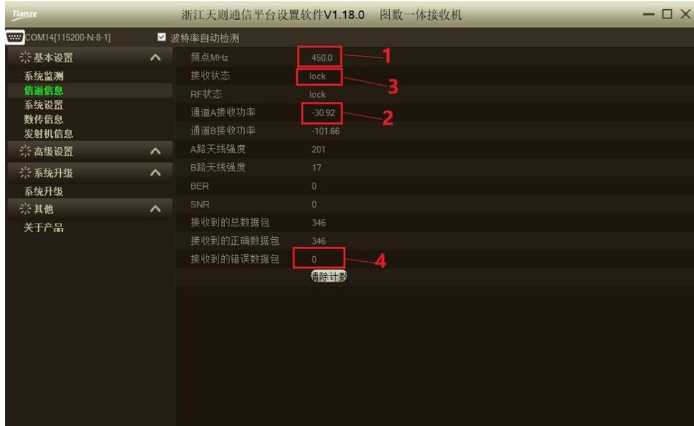
步骤 1 查询确认工作频点。接收模块与发射模块必须设置相同工作频点才能正常通信。（带有自动优选频点功能的接收模块会自动选取当前无线环境下的最佳工作频点。）
