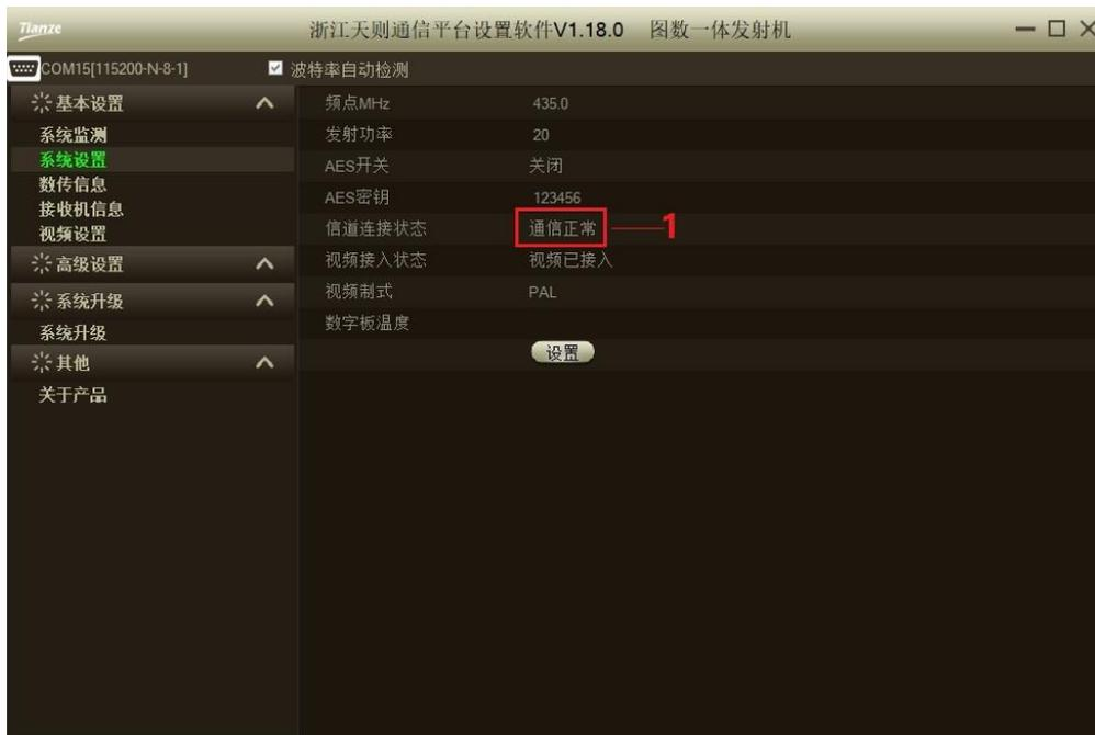
步骤 1 确认数传通道是否连接，正常连接通信后显示通信正常，否则显示故障。
