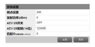
设置频点(具体频点由设备决定)发射机和接收机频点必须一致图传才能通信; AES128 开关设置为开启后,接收机也必须要开启 AES 开关,并且二者密钥必须一致
