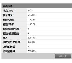
"**信道开关**"为图传当前连接状态,"UnLock"为未连接状态,"Lock"为连接**状** 态。
